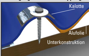
Querschnitt Befestigung vor der Überlappung
